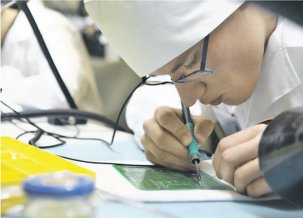
Вчера 11:50 Конкурс «Московские мастера». Один из конкурсантов — в белом халате и шапочке, как требуют правила охраны труда, — припаивает микросхему к плате
