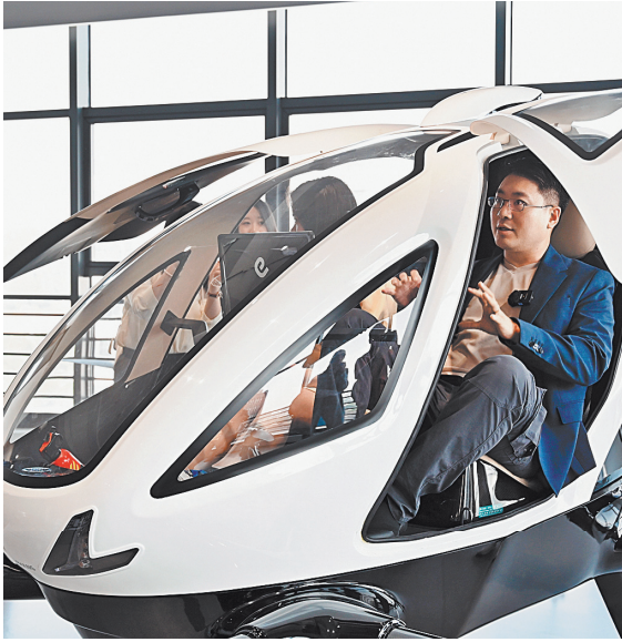
Дроны EH216-S (на снимке) на электрическом ходу развивают скорость до 130 км/ч и летают на расстояние 30 километров.
