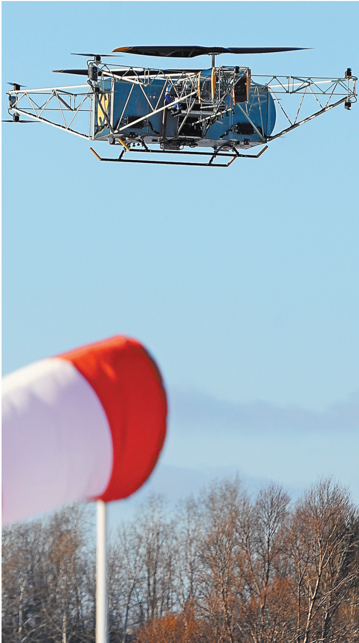
Максимальная грузоподъемность платформы составляет 400 килограммов.
