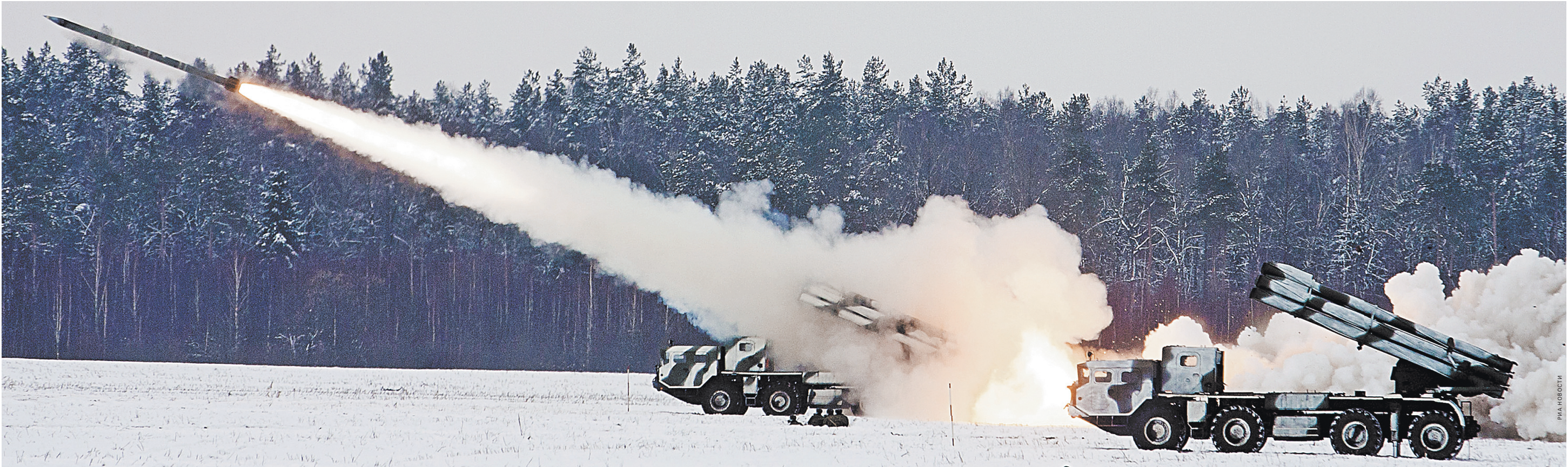
На полный залп 12 снарядами «Смерчу» необходимо не более 40 секунд, после чего реактивная система за три минуты может свернуться и покинуть позицию.
