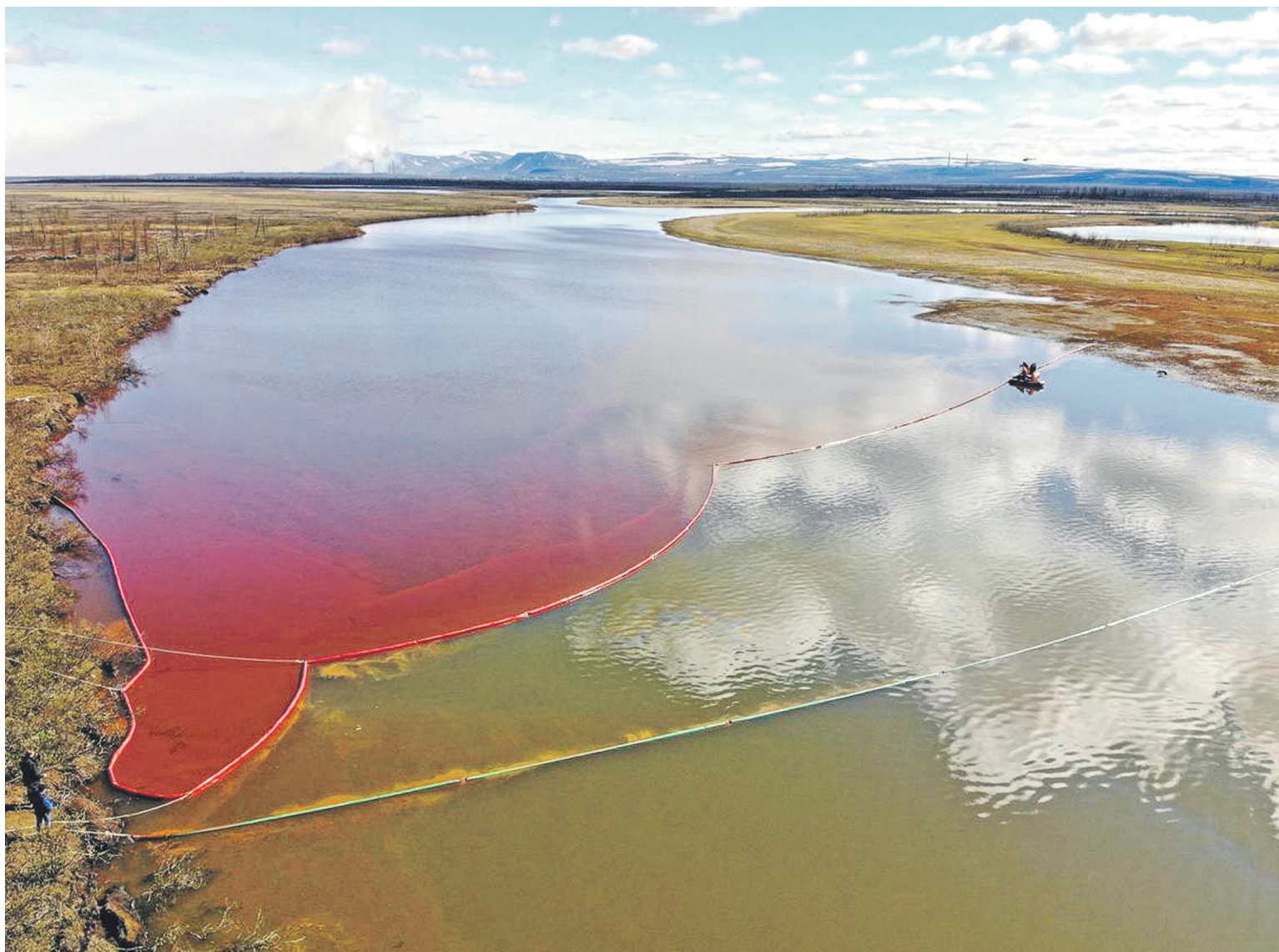
По мнению экспертов, дизтопливо содержит химические соединения, которые не улавливаются боами, и поэтому его нужно откачивать вместе с водой, но для этого в Норильске нет емкостей
